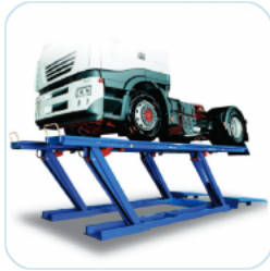
Elektrohydraulische Parallelogramm - Hebebühne für LKW / Busse / Sonderfahrzeuge / Tragfähigkeit 12.000 - 52.000 kg / je nach Ausführung Typ: OMER VEGA 120 - 180 - 240 - 340 - 450 - 520
